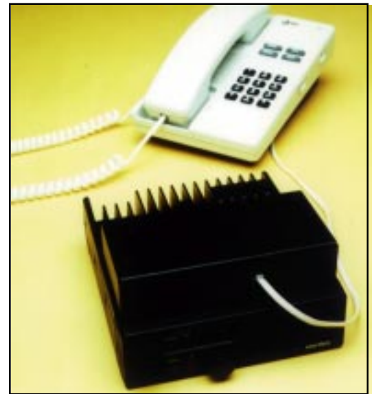
El ST-869 puede conectarse a cualquier teléfono, equipo de fax o modem de computadora. Su tamaño compacto facilita la instalación en muchos transceptores móviles.
